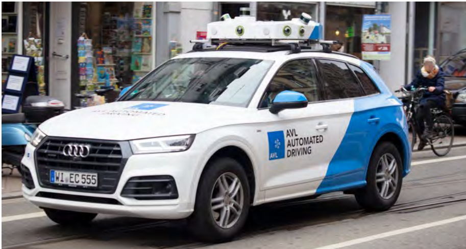
Messfahrzeug zur Erfassung von Referenzdaten in der Fahrzeugentwicklung
